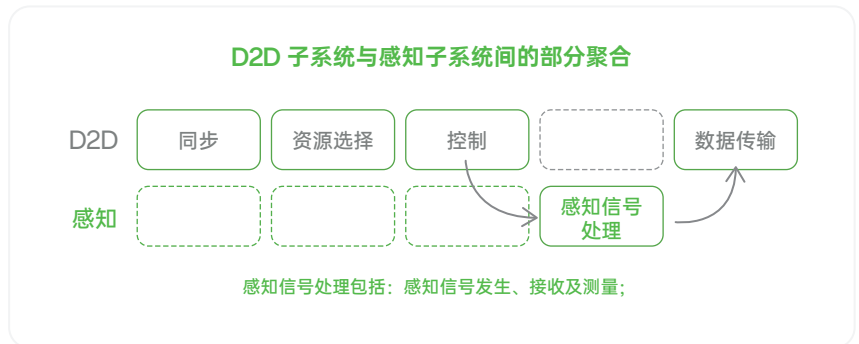
图 1-16: D2D 子系统和感知子系统间的部分聚合
