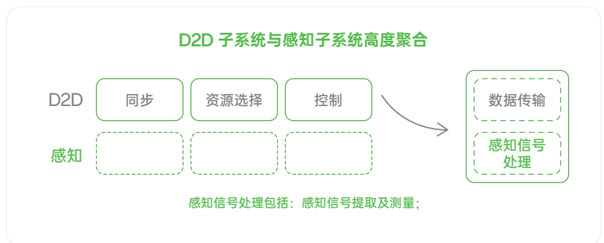
图 1-17: D2D 子系统和感知子系统间高度聚合
