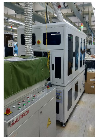
二代切角机耗电功率: 5.5kW
